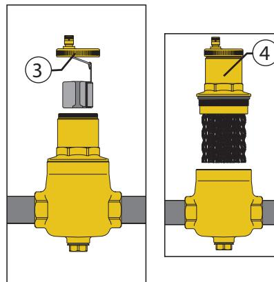
La construcción especial del separador de aire permite efectuar operaciones de mantenimiento y limpieza sin tener que retirar el dispositivo del sistema, en particular:
